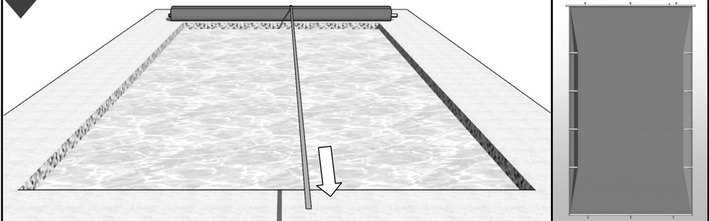
**3** Befestigen Sie die Schnallen mit einem Haken an der Abdeckung, setzen Sie die Haken auf die Schrauben und strecken Sie die Abdeckung wie unten gezeigt. **Denken Sie daran, die Schnallen in der geschlossenen Position zu lassen.**
