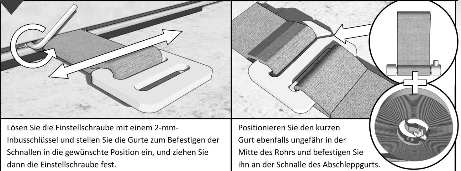
Lösen Sie die Einstellschraube mit einem 2-mm-Inbusschlüssel und stellen Sie die Gurte zum Befestigen der Schnallen in die gewünschte Position ein, und ziehen Sie dann die Einstellschraube fest.
