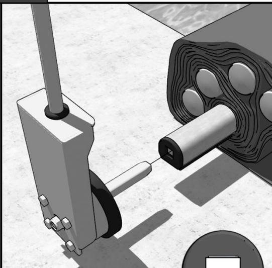
Setzen Sie den Kurbelzapfen in ein spezielles Loch im Wickelrohrstopfen ein.
