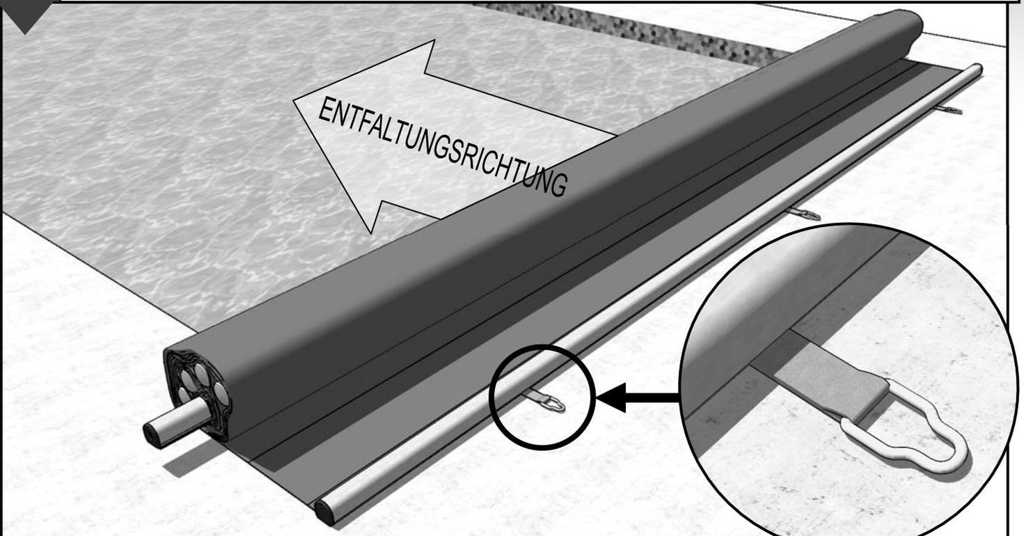
**2** Rollen Sie die Plane vollständig von Hand ab. Es ist am bequemsten, die Plane bei zwei Erwachsenen zu entfalten.
