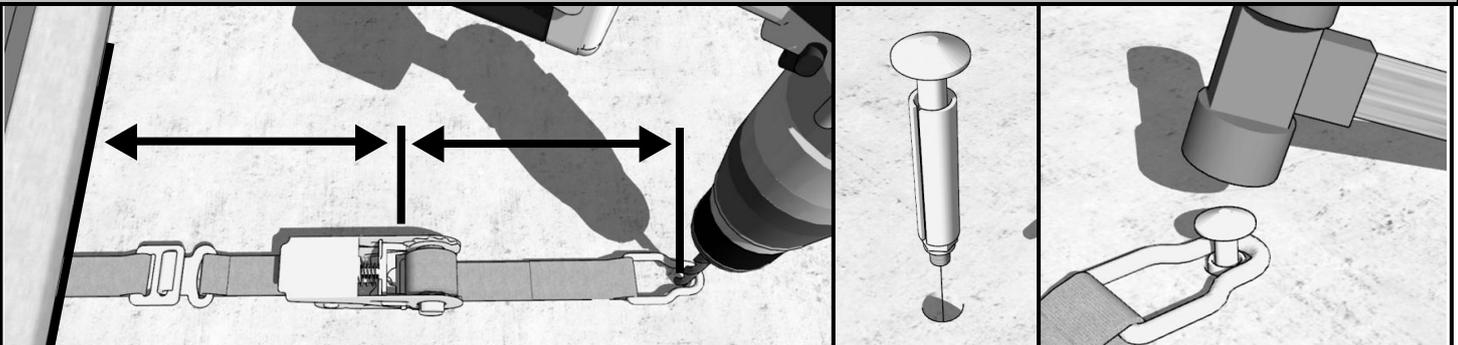
Im Abstand von ca. **35-60 cm** (Standard) von die Abdeckung Löcher für die Befestigungsschrauben mit einem  $\varnothing$  10 mm Bohrer bohren.
