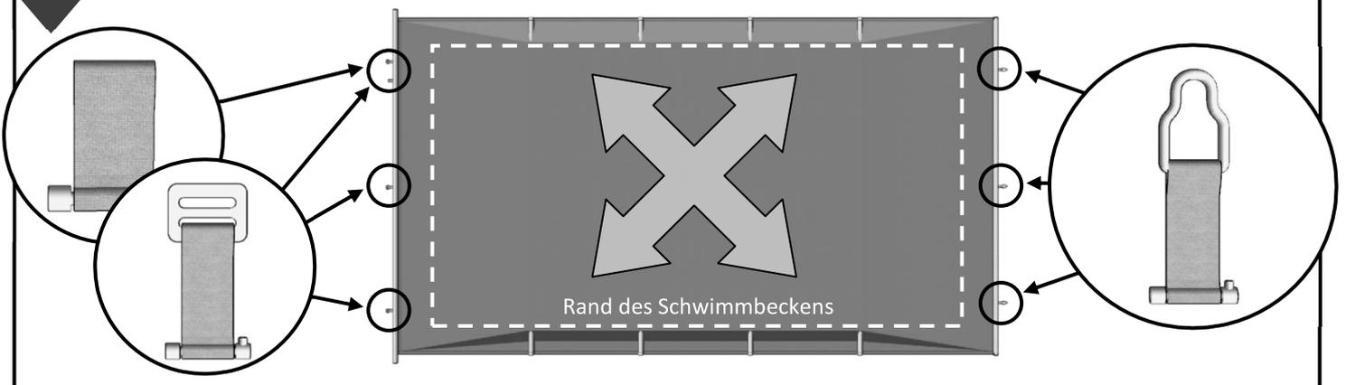
**4** Beginnen Sie mit der Montage der Befestigung von der Ablage-seite der aufgerollten Abdeckung (Endrohr).
