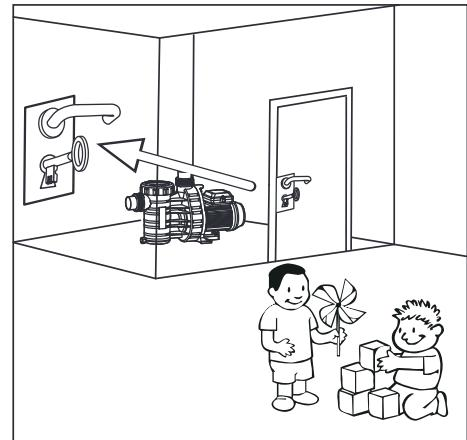
Veiller à la bonne aération de la pompe par le ventilateur (pour que l'air puisse circuler librement, il n'est pas recommandé d'isoler la pompe avec de la laine de verre par exemple). La pompe doit être installée dans un endroit au sec et bien aéré. Eviter de stocker des objets à proximité de la pompe.
