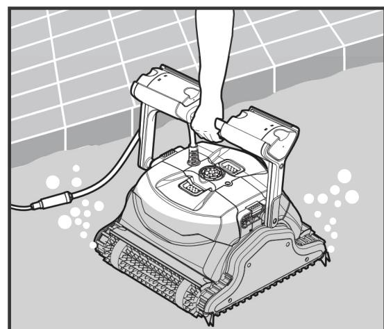
Stellen Sie das Stromversorgungsgerät auf ON.
