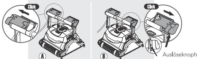
Um den Schwimmkörper wieder in seine ursprüngliche Position zurückzuschieben: schieben Sie den Griff-Schwimmkörper zurück, während Sie auf den Auslöseknopf auf der Basis des Griff-Schwimmkörpers drücken.
